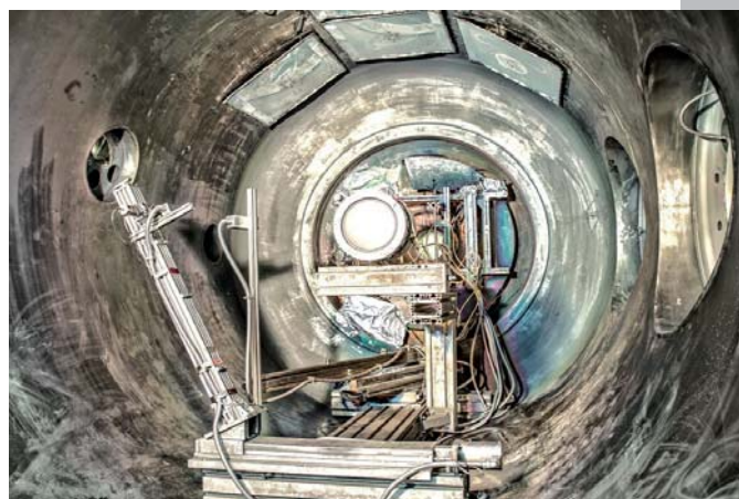
Blick in den Jumbo auf ein Ionentriebwerk mit Strahlendiagnostik. Fotos: IPI/JLU
