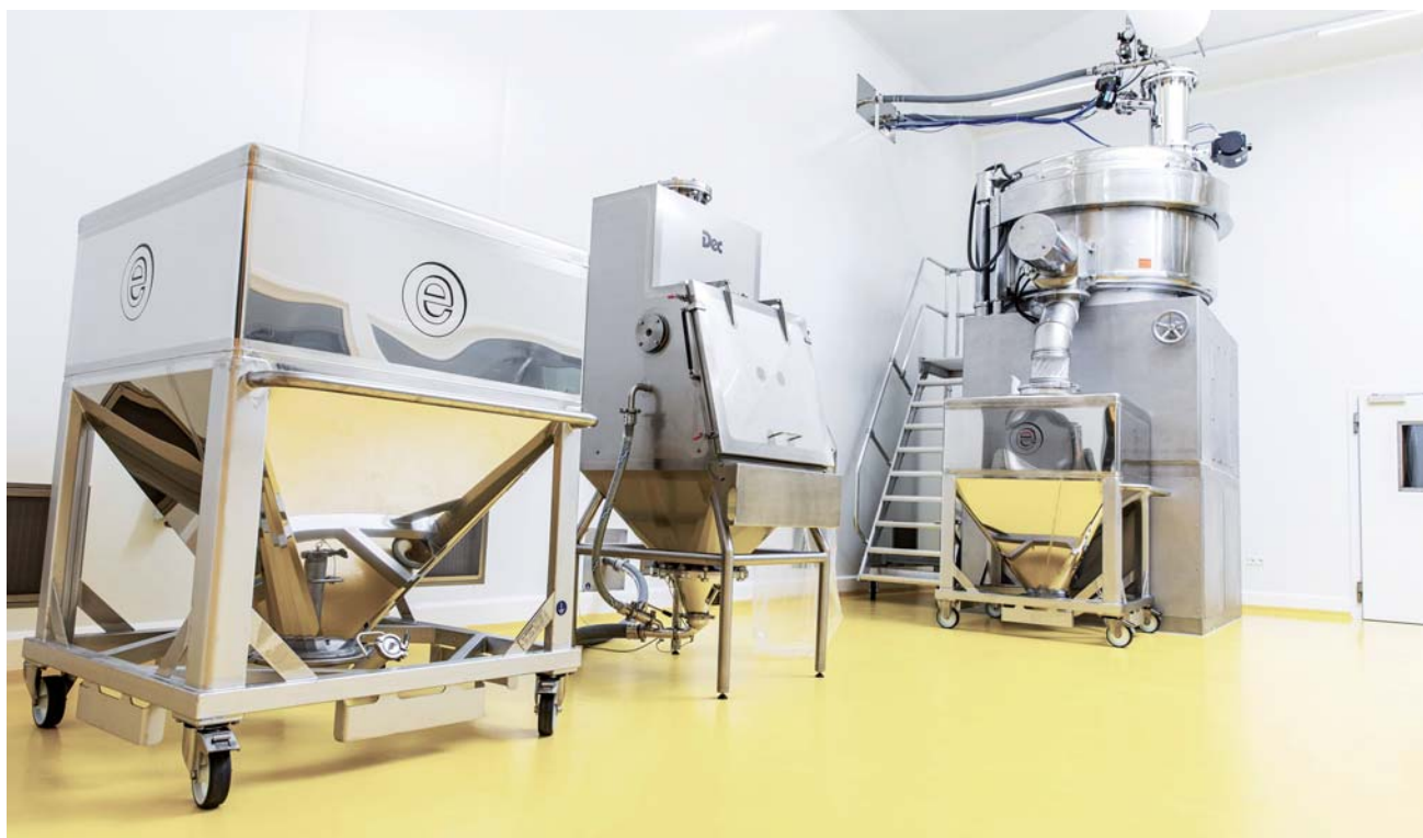
Ebbecke Reinraumkonzept, zu sehen ist ein Pharmamischer (sogenannter API-Mischer).
