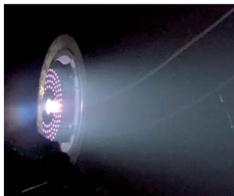
Das Gitterionentriebwerk IonJet-Evo im Testbetrieb mit Extraktion eines Xenon-Ionenstrahles. Foto: F. Scholze, IOM
