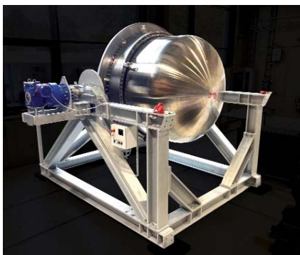
Prüfstand für Berst- und Systemtests vollskaliger CFK-Wasserstoff-Halbtanks unter kryogenen Bedingungen. Foto: DLR
