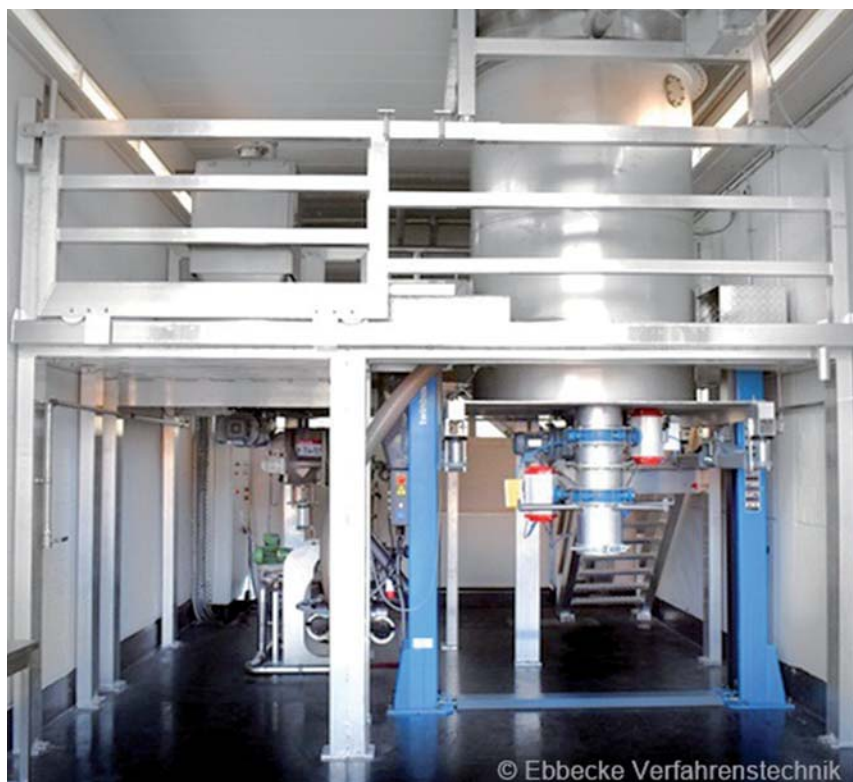
Ebbecke Spiralstrahlmühle (ESM 500): Feinmikronisierung von Produkten unter technisch-hygienischen Standards.
