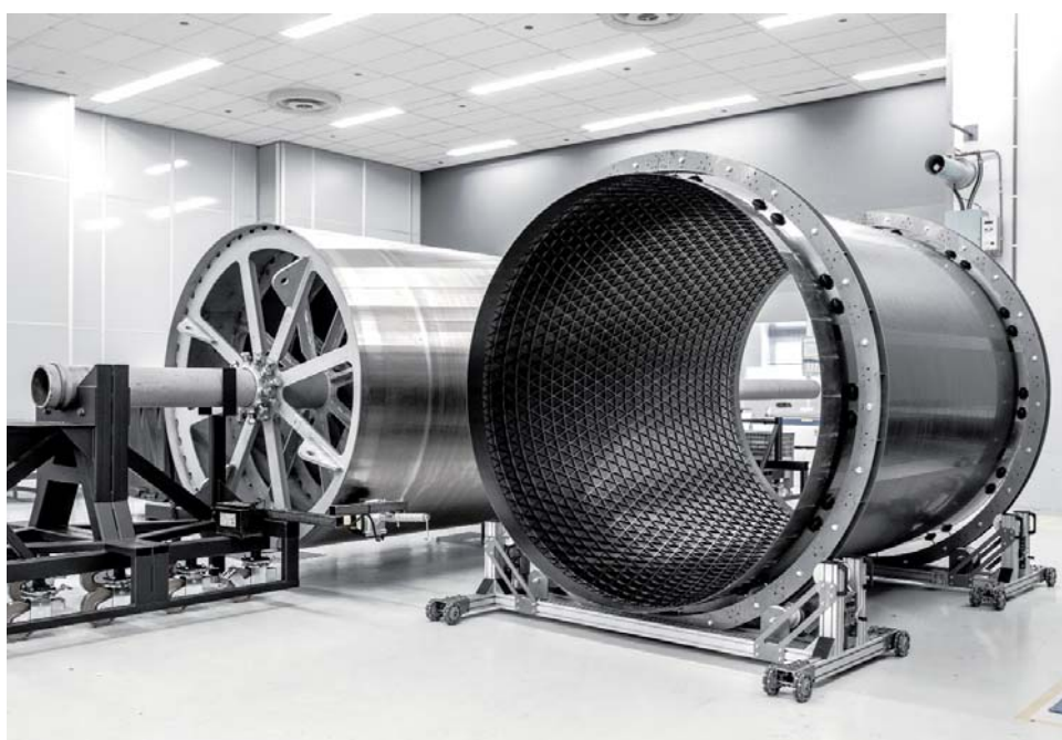
Mandrel mit Composite-Wickelstruktur für zylindrische Raumfahrtbauteile. Foto: ATG europe
