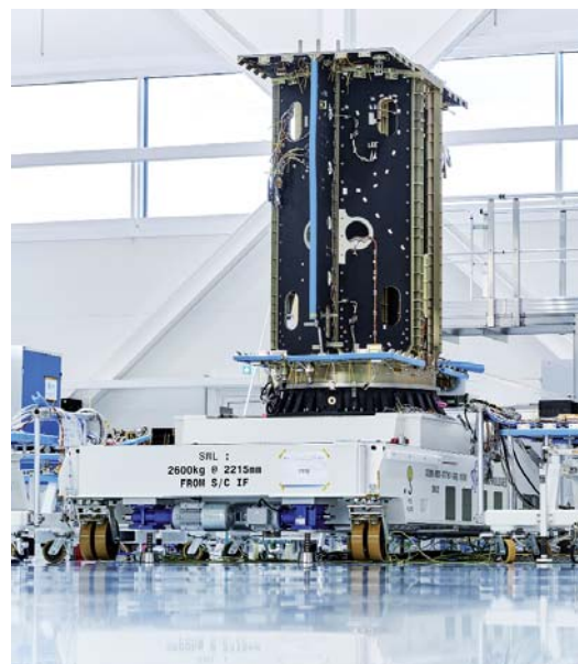
Blick in den Reinraum des Raumfahrtunternehmens OHB: Einer der drei CO2M-Satelliten ist hier in seiner frühen Phase des Baus zu sehen. Fotos: OHB
