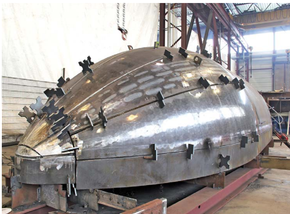
Formwerkzeug für die Nutzlastverkleidung der Vega-C-Rakete. Foto: Ostseestaal GmbH & Co. KG
