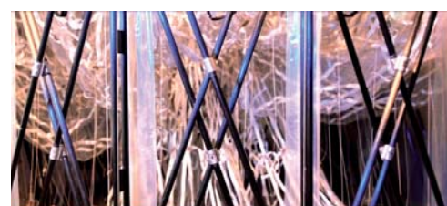
Nahaufnahme des LEOB-Reflektor Ingenieurmodells mit Details des äußeren Ringes und des Kabel-Netzwerkes, das nach Entfaltung die RF-Oberfläche bildet. Fotos: LSS
