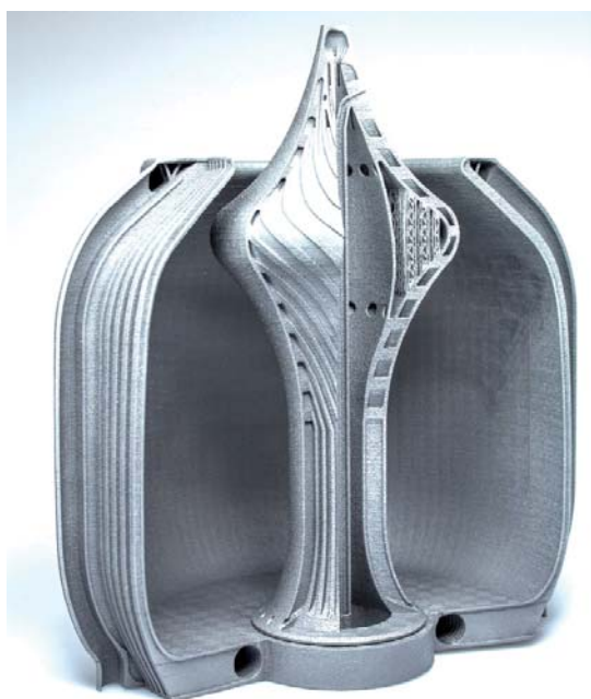
Aufgeschnittener Demonstrator des AEROSpike-Triebwerks. Foto: Institut für Luft- und Raumfahrttechnik (ILR)
