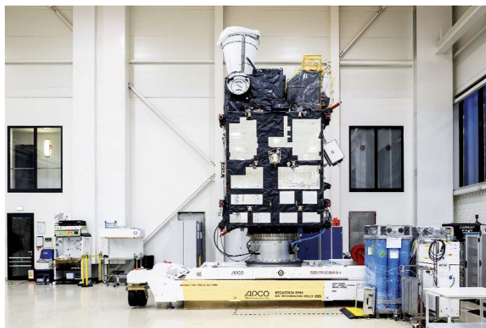
Der neue europäische Wettersatellit MTG-S1 hier in einem Reinraum bei OHB, bevor er im Juli 2025 gestartet wurde. Mit seinem Infrarot-Sounder-Instrument wird er die Wettervorhersagen erheblich verbessern.
