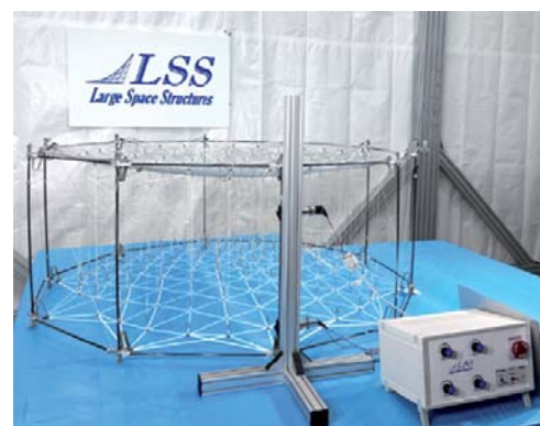
KaMPER-Reflektor (1 m Apertur) für Ka-Band Betrieb, unter Verwendung der „LSS-2“ Ring-Architektur.
