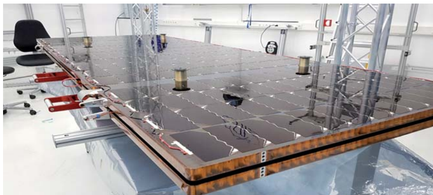
Ausklappbarer Solargenerator im STI-Reinraum. Fotos: STI
