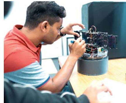
Floatsat Mockup mit Solarzellen. Bei Floatsat schweben Halbkugeln in einem Luftlager, wodurch praktisch keine Reibung entsteht und Lageregelungen für die Schwerelosigkeit programmiert werden kann. Fotos: Tobias Hage, Uni Würzburg.
