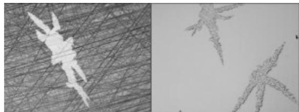
Abb. 3: Oberfläche der verwendeten Si-Substrate nach Abtrag von 1-2  $\mu\text{m}$  (links) und nach Abtrag von ca. 30  $\mu\text{m}$  (rechts).
