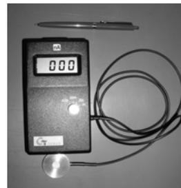
Abb. 3: Monitorgerät zur Messung und Überwachung von 172-nm-Excimerstrahlern
