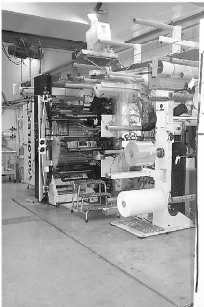
Abb. 1: Pilotanlage Flexodruckmaschine „Soloflex“
