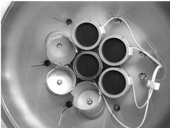
**Abb. 1:** Geclusterte Ionenstrahlquelle zur Erzeugung großflächiger und fokussierter Ionenstromdichteverteilungen
